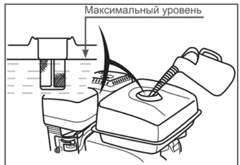
Рис. 12 Максимальный уровень топлива в топливном баке
