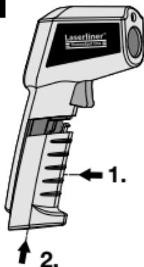
Tänk på att vända batteriernas poler åt rätt håll.
