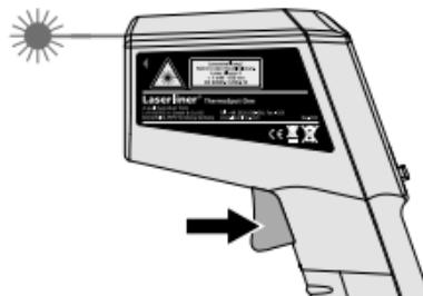
Відразу після потрапляння плями націльного лазера в бажане місце виміру кнопку звільнити. Виміряне значення зафіксується.
