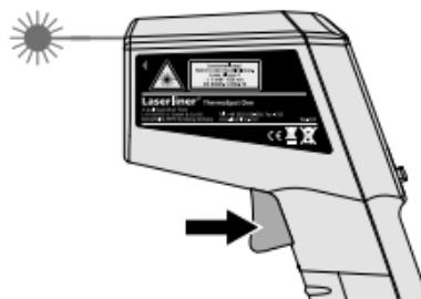
Отпустить кнопку, как только направленный луч лазера попадет на нужный участок измерений. Результат измерения удерживается на экране.
