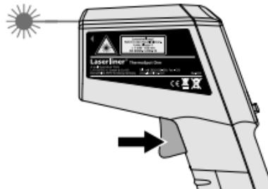
Non appena il punto da misurare è stato rilevato con il laser di puntamento, rilasciare il tasto. Il valore misurato rimane visualizzato.
