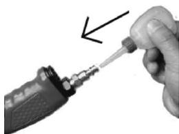
■ Если лубризатор отсутствует, необходимо вручную закапывать 2–6 капель специального масла во впускной воздушный штуцер инструмента один раз в день или после двух часов работы.
