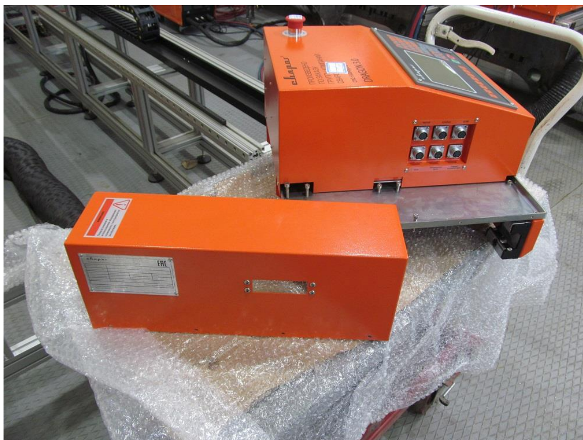
Рис.16 Кожух корпуса контроллера
