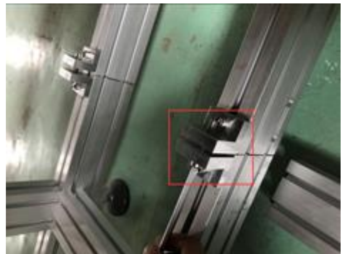
Рис.11 Стыковка секций 6-ти метрового станка (2500х6000)
