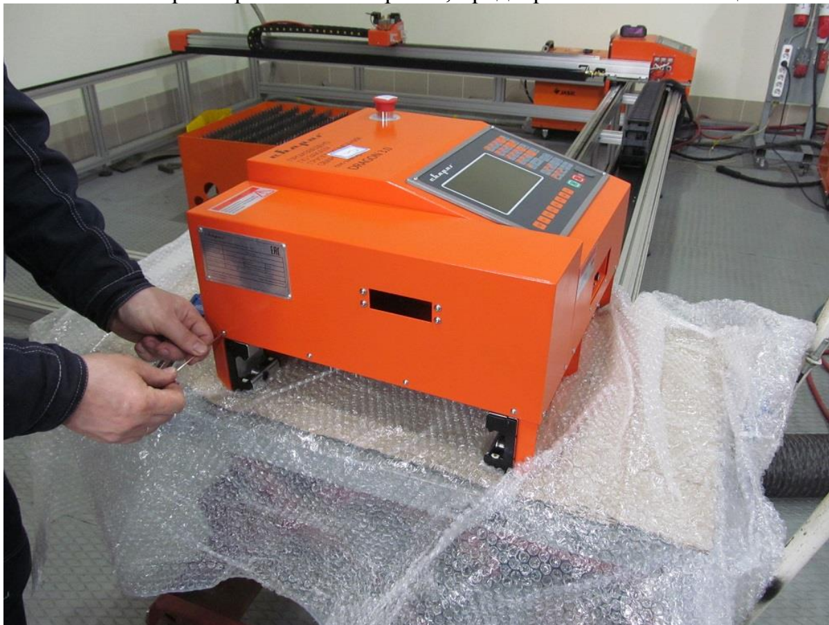
Рис.15 Демонтаж защитного кожуха контроллера
