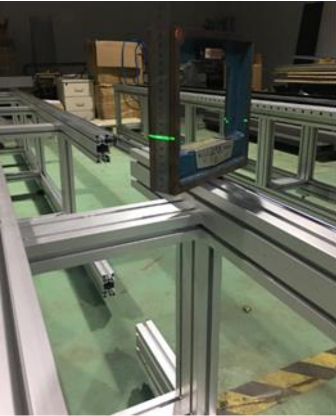
Рис.9 Регулировка уровня стоек.
