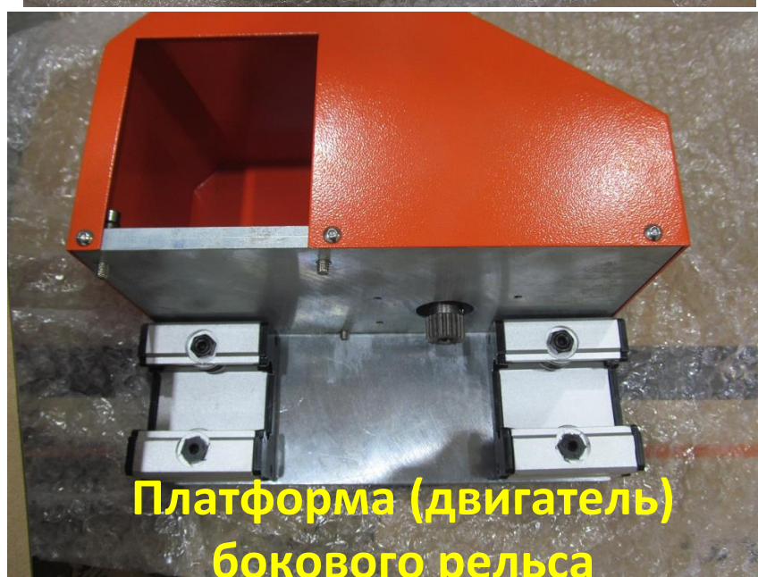
Рис.6 Комплектующие станка. Контроллер. Защитный экран контроллера. Платформа (двигатель) бокового рельса.
