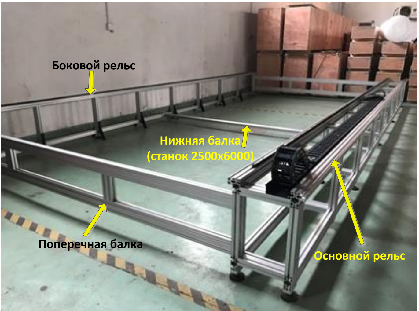
Рис.7 Корпус станка. Вариант 6-ти метрового станка (2500x6000).
