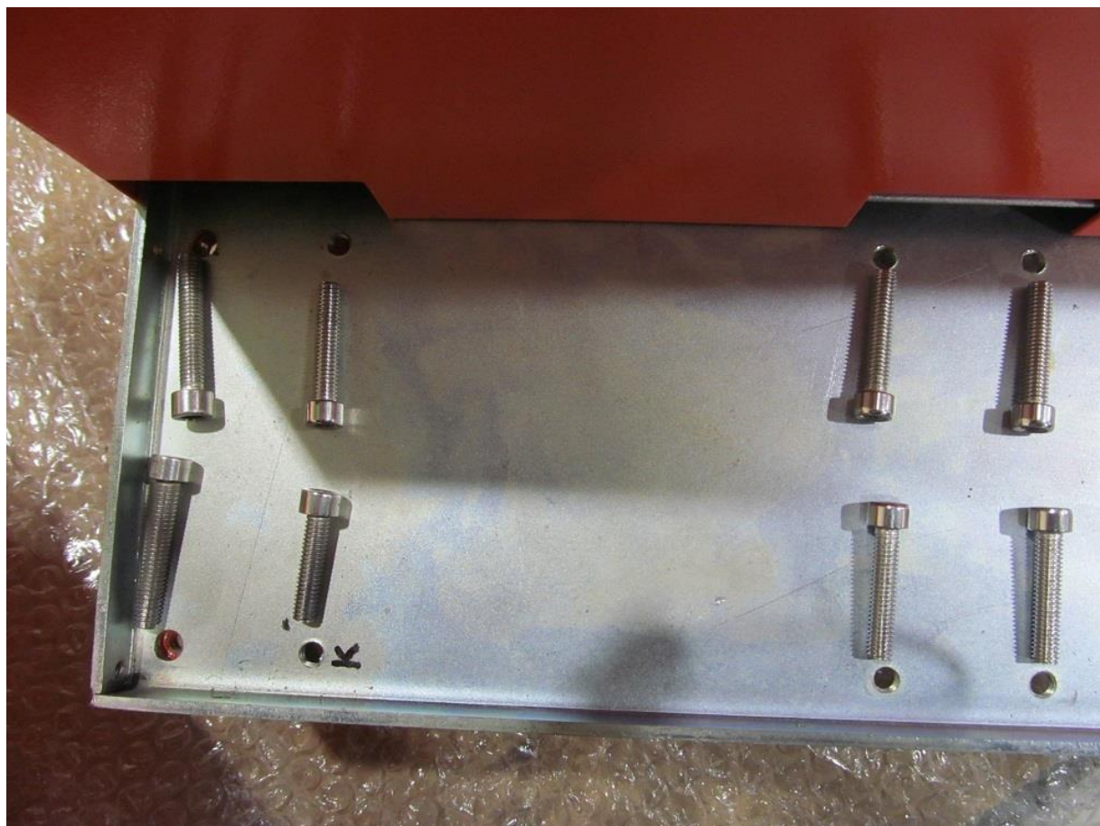
Рис.18 Расположение винтов крепления поперечного рельса
