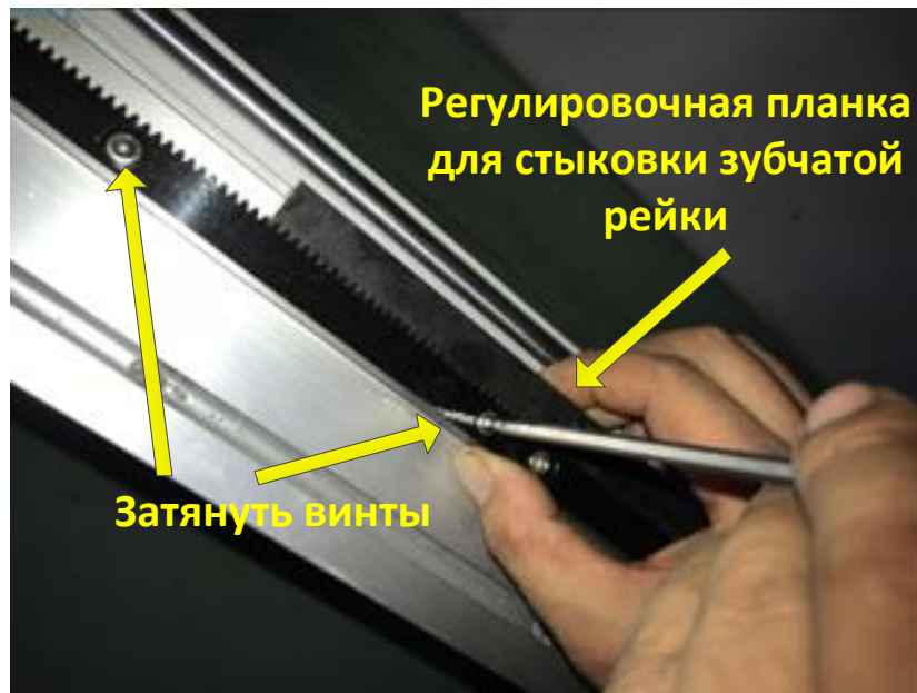
Рис.12 Стыковка секций бокового рельса 6-ти метрового станка (2500x6000)
