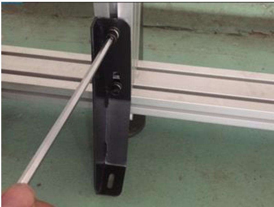
Рис.14 Установка фиксаторов стоек
