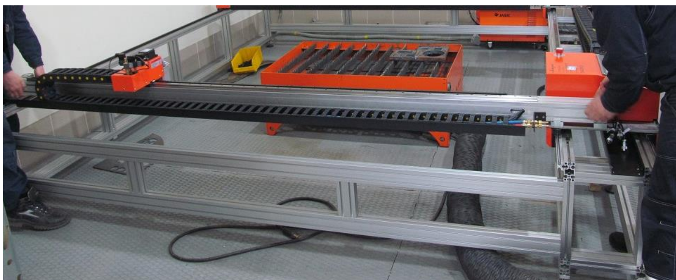
Рис.24 Установка поперечного рельса
