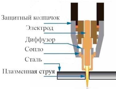
Плазменной резкой можно резать практически любой металл, включая сталь, нержавеющую сталь, алюминий, латунь, медь и т. д. Можно резать любую толщину от 0,5 до 12 мм, в зависимости от выставленной силы тока.
