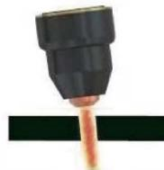
Резак расположен под углом к материали неравномерно, одна сторона может быть чрезмерно скосена. Проверьте надежность соединения сетевого кабеля.
