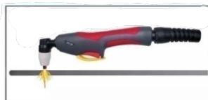
При резке убедитесь, что искры выходят из нижней части заготовки.
