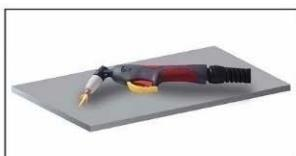
Держите резак под углом к заготовке, нажмите кнопку, чтобы зажглась дуга, и медленно поверните его в вертикальное положение.
