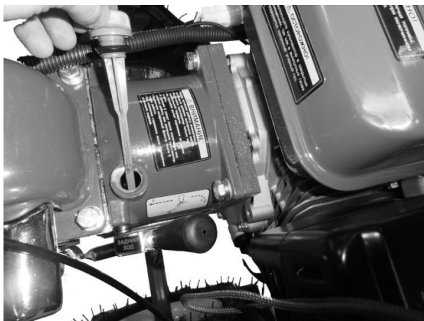
Рисунок 6 – Проверка уровня масла в корпусе редуктора
