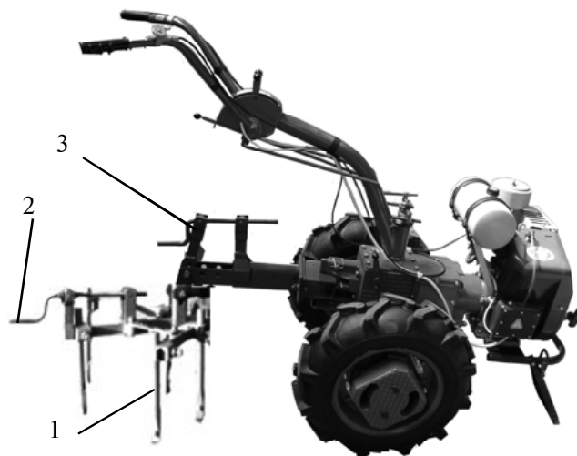
1 - рыхлитель, 2 - рукоятка рыхлителя, 3 - универсальное устройство поворотного механизма
