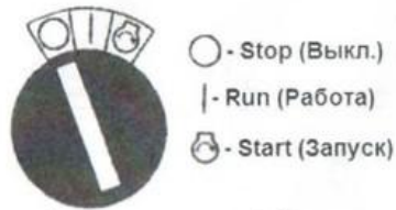
Рис. 16 Замок зажигания (электростартер). Ключ в положении "0" ("Stop" – "Выкл.")
