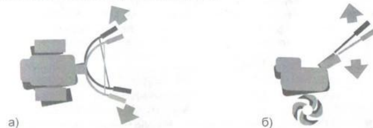
Рис.10 Схемы снятия нагрузки с валов при использовании механизма разобщения полуосей
