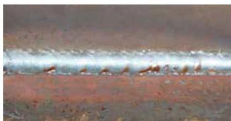
Рис 9.2. Сварной шов при максимальном значении индуктивности.
