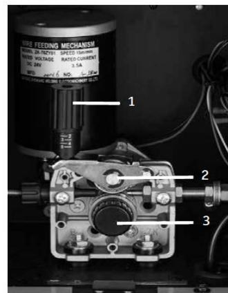
Рис. 4. Вид подающего механизма.
