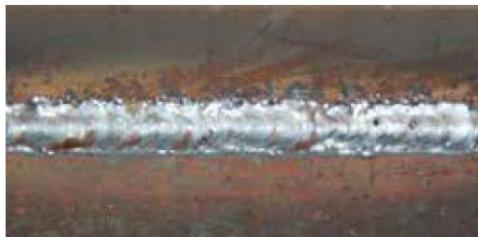
Рис 9.1. Сварной шов при минимальном значении индуктивности.
