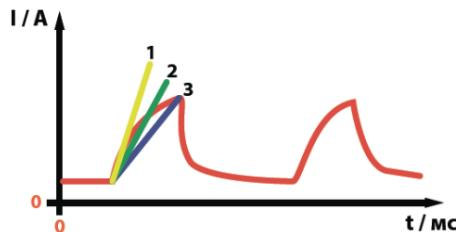
Рис. 8. График зависимости сварочного тока от индуктивности.
