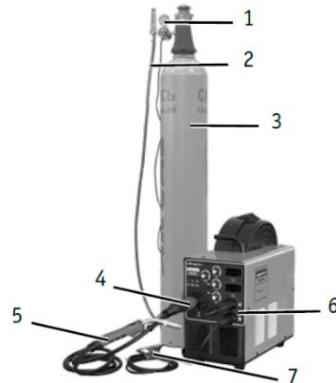
Рис. 3. Схема подключения оборудования для MIG, MAG И FCAW сварки
