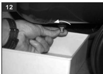
■ После смены масла тщательно заверните крышку заливного отверстия (рис. 11), проверьте на утечку во время работы компрессора.
