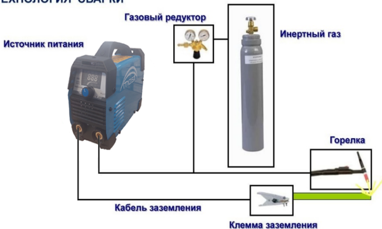
Рисунок 5.2 Схема подключения оборудования для TIG сварки
