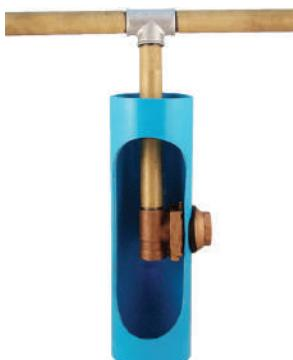
2. С помощью монтажного устройства установите в отверстие на обсадной трубе фиксируемую часть адаптера и наживите гайку. Выньте монтажное устройство со съемной частью адаптера. Поверните фиксируемую часть на 180° и полностью затяните гайку.
