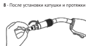
9 – прикрутить сварочный наконечник
