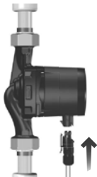
Рис. 10 Подключение к электросети
