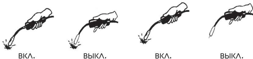
Рисунок 9 – Работа со сварочной горелкой в режиме 4Т.
