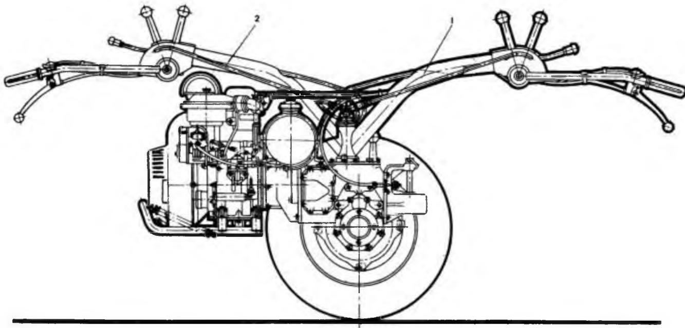
Рисунок 18 – Схема положения рулевой штанги
