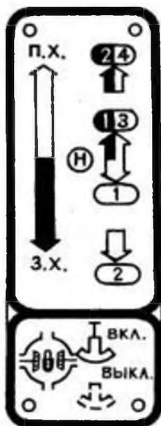
Рукоятка управления блокировкой дифференциала 10 (рис.3) установлена на пульте рулевой штанги. Переднее положение рукоятки соответствует включенной блокировке, а заднее положение – выключенной блокировке дифференциала (рис.4).
