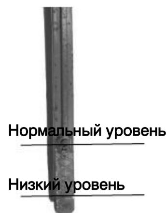
Снимите крышку с отверстия для масла и протрите измерительный щуп.
