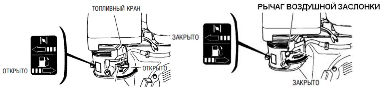
**⚠ ВНИМАНИЕ! Если двигатель горячий, нет необходимости закрывать воздушную заслонку. Никогда не давайте работать двигателю длительное время при закрытой воздушной заслонке. Это приведет к поломке двигателя и снятию с гарантии.**
