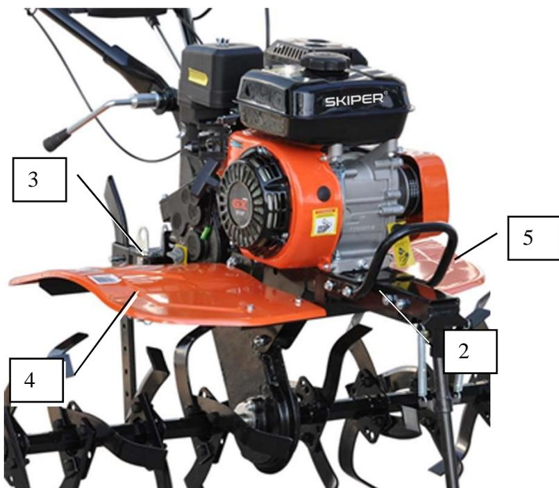
Установите переднюю планку 2 в перевернутом положении спереди рамы культиватора. Совместите с отверстиями базового кронштейна. Закрепите переднюю планку 2 с помощью 2-х болтов 1.
