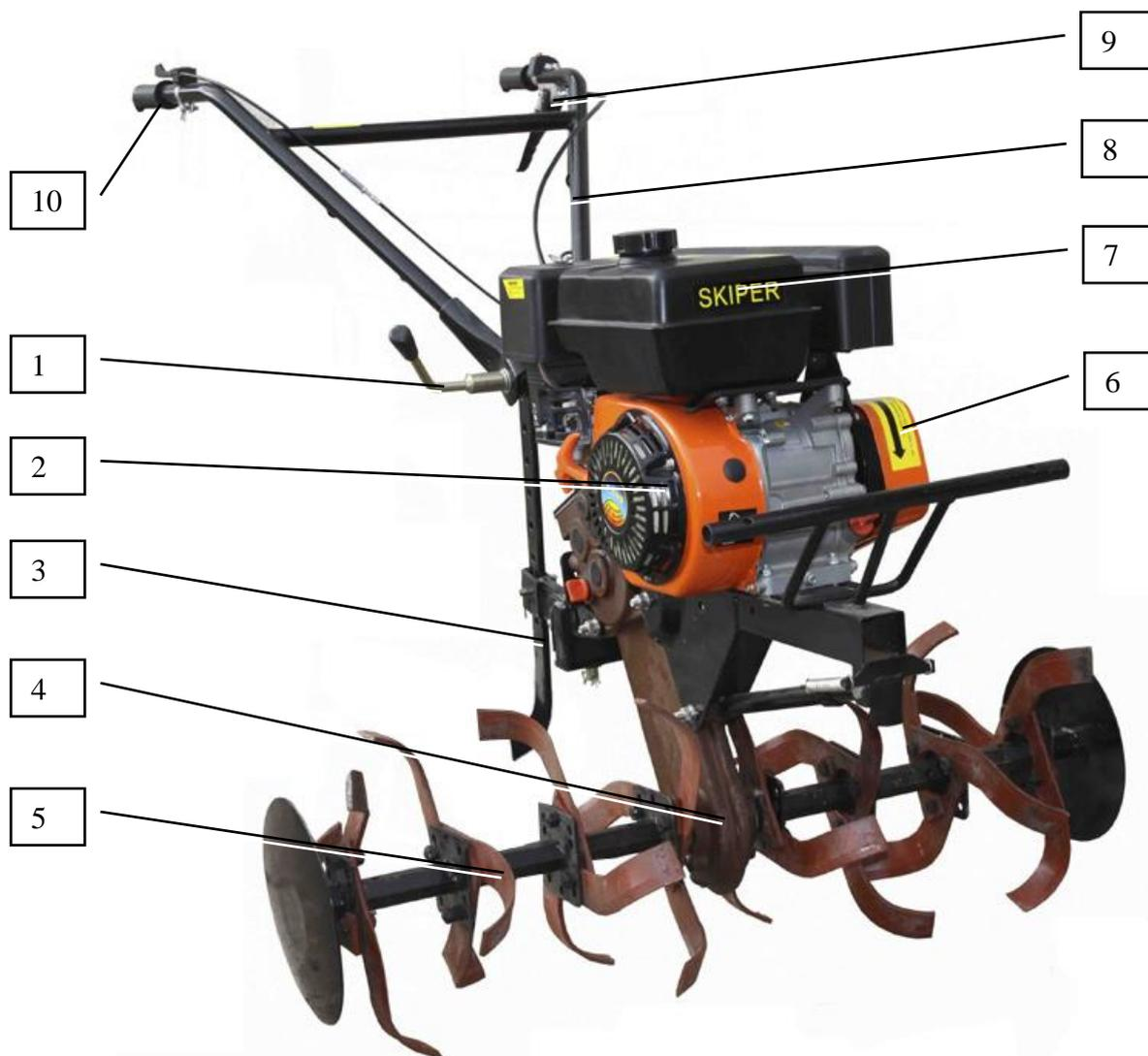
1. Ручка регулировки вертикального положения рукоятки управления
