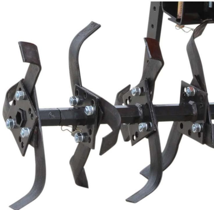
На модели культиваторов GT-1000S, GT-1400S, GT-1600S, GT-1800S, GT-1000SB, GT-1400SB, GT-1600SB, GT-1800SB установку ножей выполняйте по четыре штуки на фланец вала. Следите за тем, чтобы острие ножей и их изгиб были направлены в одну сторону. Установку ножей на разные валы необходимо выполнять с зеркальным отражением. Необходимо устанавливать каждую группу из 4 ножей на соседнем фланце с небольшим смещением.
