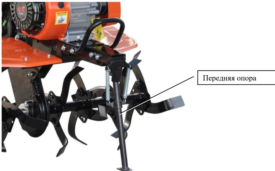
Установите скобу передней опоры на раму устройства так, чтобы совпали оба отверстия на скобе с отверстиями на раме. Затем в отверстия вставьте болты и закрепите его шайбой и гайкой. Ножка опоры может откидываться назад, что позволяет ее фиксировать в таком положении, когда выполняется работа в поле.
