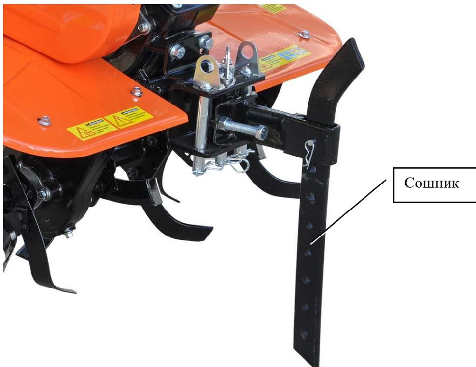
Установите переходник на раму культиватора и закрепите его. Вставьте в переходник сошник и зафиксируйте нужную высоту пальцем и шплинтом. Установите рамку и закрепите ее к опоре шурупом.
