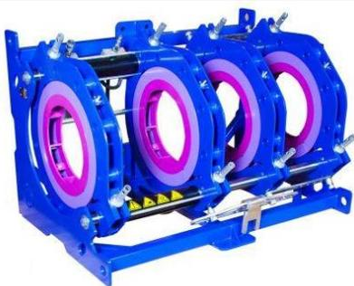
**Центратор**- предназначен для центрирования и выравнивания торцов труб и соединительных деталей. Состоит из стальной рамы, пары подвижных хомутов, приводимых в движение гидравлическими цилиндрами и пары неподвижных хомутов. Диаметр свариваемых труб от 315 мм до 630 мм (в стандартную комплектацию входят диаметры 315, 355, 400, 450, 500, 560 мм)
