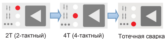
Рисунок 9: Выбор режима сварки / цифровое управление.
