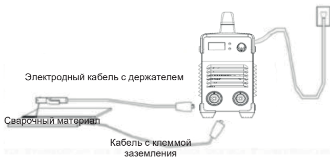
Рисунок 2: Зажигание сварочной дуги при сварке покрытым электродом ММА.
