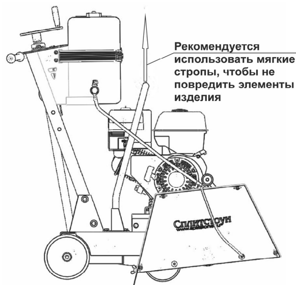
Рисунок 14 – Схема строповки резчика при погрузке/разгрузке
