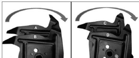
Рис. 3 Маркировка и направление вращения фрез
