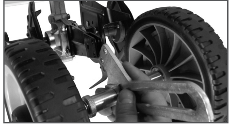
Рис. 6 Установка кронштейна колес
