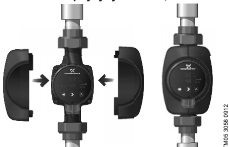
8-сүр. Соркысманын корпусунун изоляцисы
