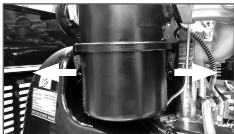
Рис. 16 Снятие стакана воздухоочистителя
