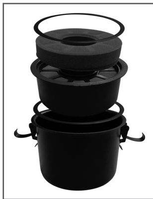
Рис. 21 Установка воздушного фильтра в стакан воздухоочистителя
