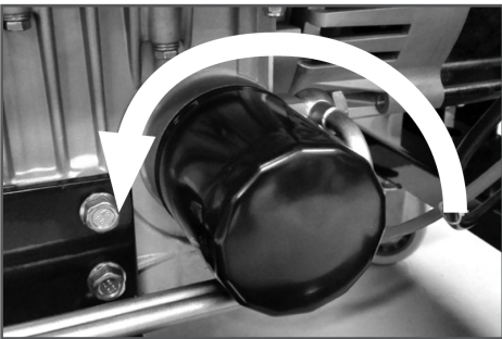
Рис. 15 Замена масляного фильтра
