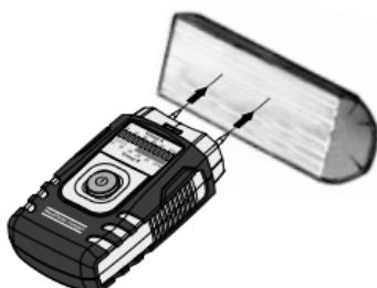
Mittauskohdan tulisi olla käsittelemätöntä puuta eikä siinä saa olla oksankohtaa, likaa eikä pihkaa. Älä mittaa laudan päästä äläkä etupuolelta, koska puu kuivuu tällaisissa paikoissa nopeammin; mittaustulos saattaa olla virheellinen.
