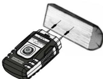
Το προς μέτρηση σημείο θα πρέπει να είναι ακατέργαστο και χωρίς κλαδιά, ρύπους ή ρητίνη. Δεν θα πρέπει να εκτελούνται μετρήσεις σε μετωπικές πλευρές, επειδή το ξύλο εκεί στεγνώνει πολύ γρήγορα και συνεπώς δεν θα υπάρχουν αξιόπιστα αποτελέσματα μέτρησης.
