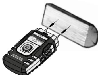
Місце для вимірювання повинне бути неопрацьованим і вільним від гілок, бруду або смоли. Не виконувати вимірювання на торцевих сторонах, тому що деревина тут особливо швидко висихає та таким чином сприяє отриманню помилкових результатів вимірювання.
