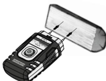
Die zu messende Stelle sollte unbehandelt und frei von Ästen, Schmutz oder Harz sein. Es sollten keine Messung an Stirnseiten durchgeführt werden, da das Holz hier besonders schnell trocknet und somit zu verfälschten Messergebnissen führen würde.
