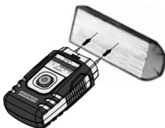
Stedet som skal måles skal være ubehandlet og fritt for grener, smuss eller harpiks. Det skal ikke utføres en måling på frontsider, for treet tørker spesielt fort der og dette kunne gi gale måleresultater.
