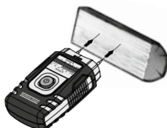
De te meten plek dient onbehandeld en vrij van takken, verontreinigingen of hars te zijn. Er dient géén meting aan de kopse zijden te worden uitgevoerd omdat het hout hier bijzonder snel droogt , hetgeen zou leiden tot vervalste meetresultaten.
