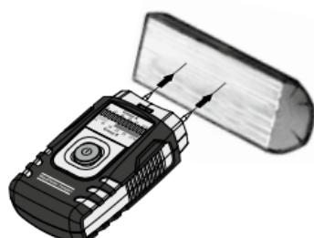
O sítio a medir não deve estar tratado nem deve ter ramos, sujidade ou resina. Não devem ser efectuadas medições em lados frontais, uma vez que a madeira aqui seca particularmente depressa e, dessa forma, levaria a resultados de medição falsos.
