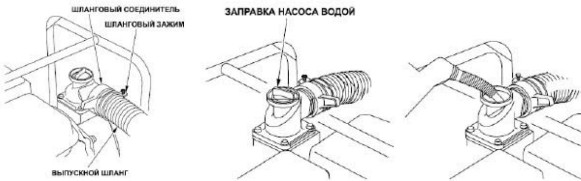
11. Запустите двигатель и убедитесь, что мотопомпа подает воду. В противном случае следует остановить двигатель. При нормальной работе мотопомпы установите рычаг управления двигателем в положение, соответствующее минимально устойчивым оборотам двигателя и прогрейте двигатель в течение 1-2 минут.
